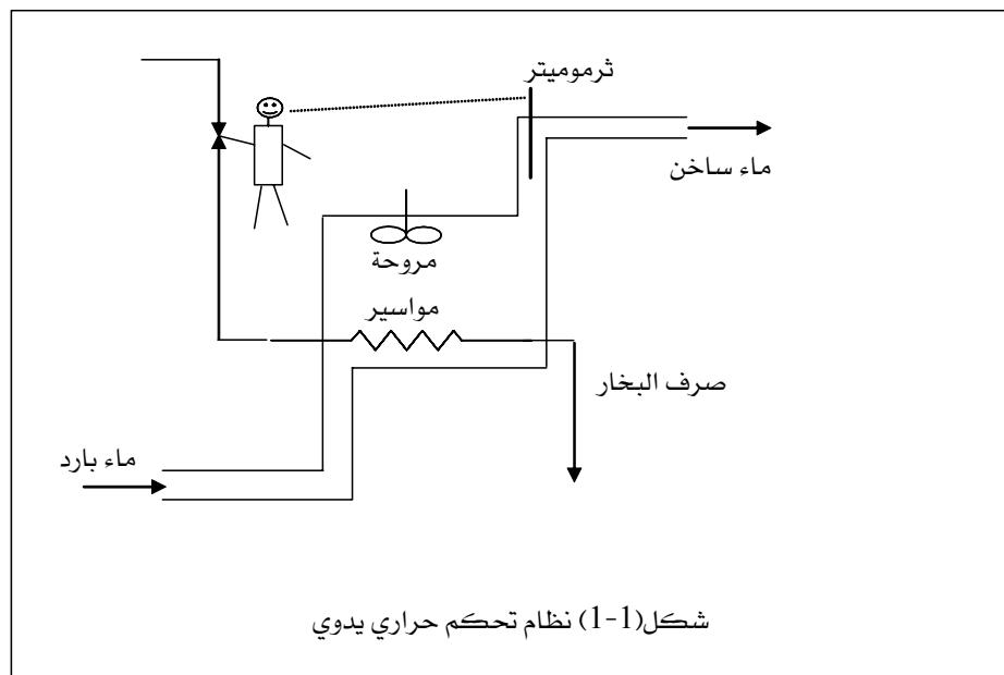
وبذلك ترتفع درجة حرارة المياه . وإذا لوحظ أن درجة حرارة المياه أكثر من اللازم يقوم بتنقیل فتحة صمام البخار. وبذلك يتم التحكم هنا عن طريق الإنسان ولهذا يسمى تحكم يدوي.
